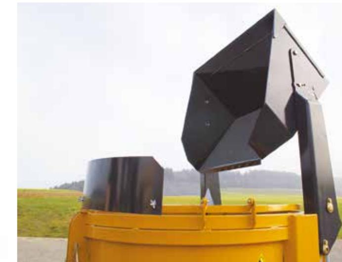
Modely TM125 a TM150 mohou být vybaveny také vlastním nakládacím zařízením. Nakládací lopata je tvarovaná tak, že při jejím zvednutí vysype celý svůj obsah do míchačky.
